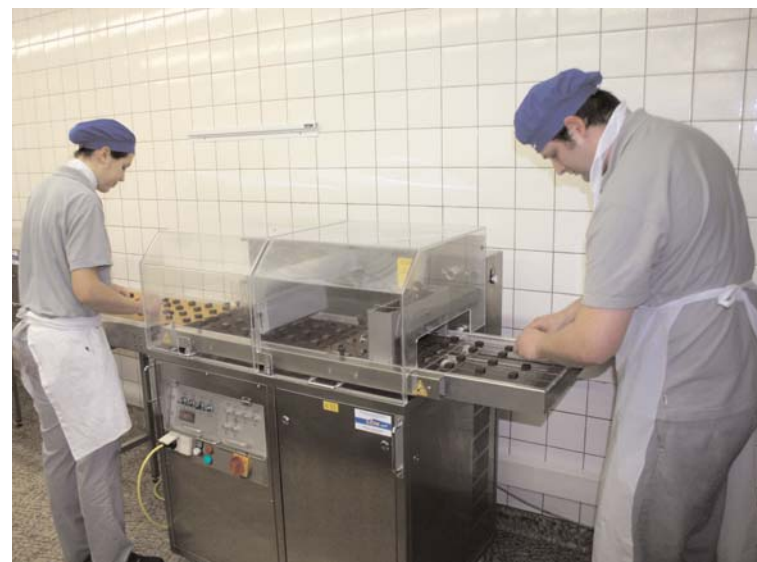
Rationelles Arbeiten mit der Schokoladenüberzugsmaschine LCM.
